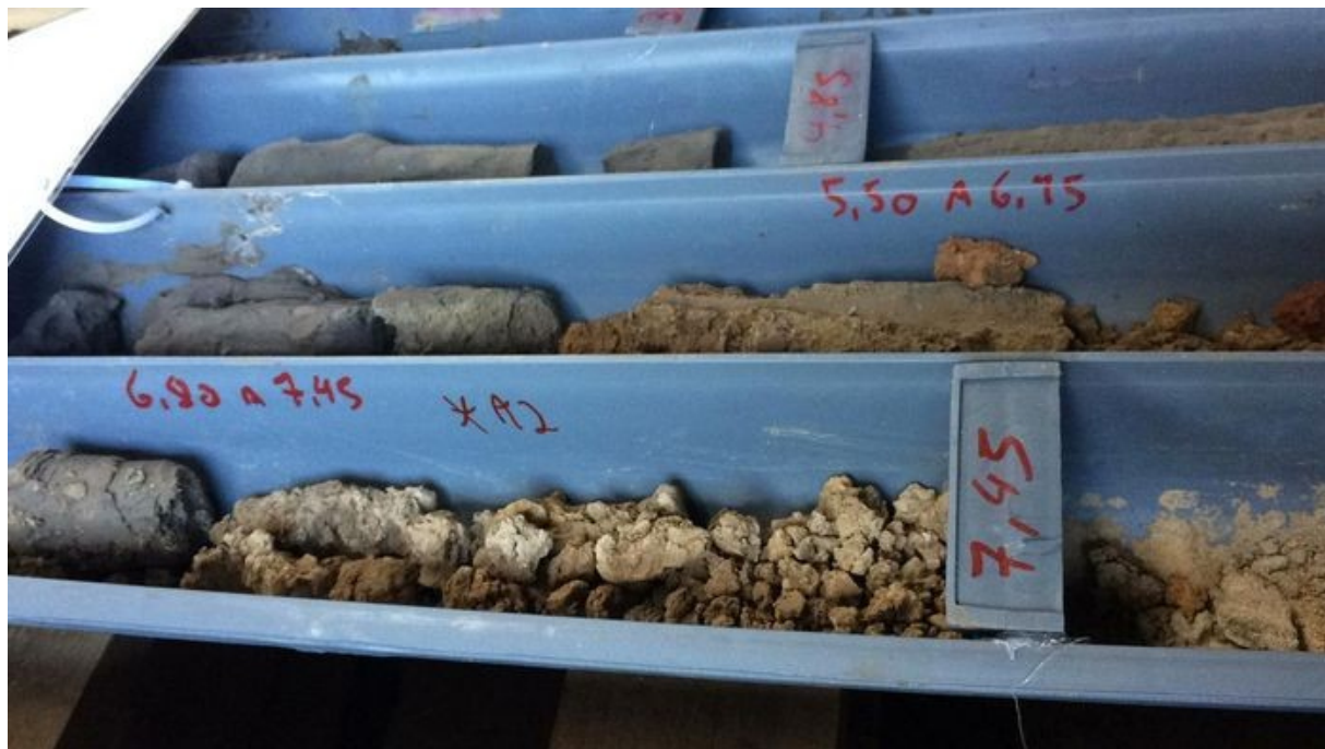
Figura 14 - Identificação das profundidades e das amostragens na caixa.
