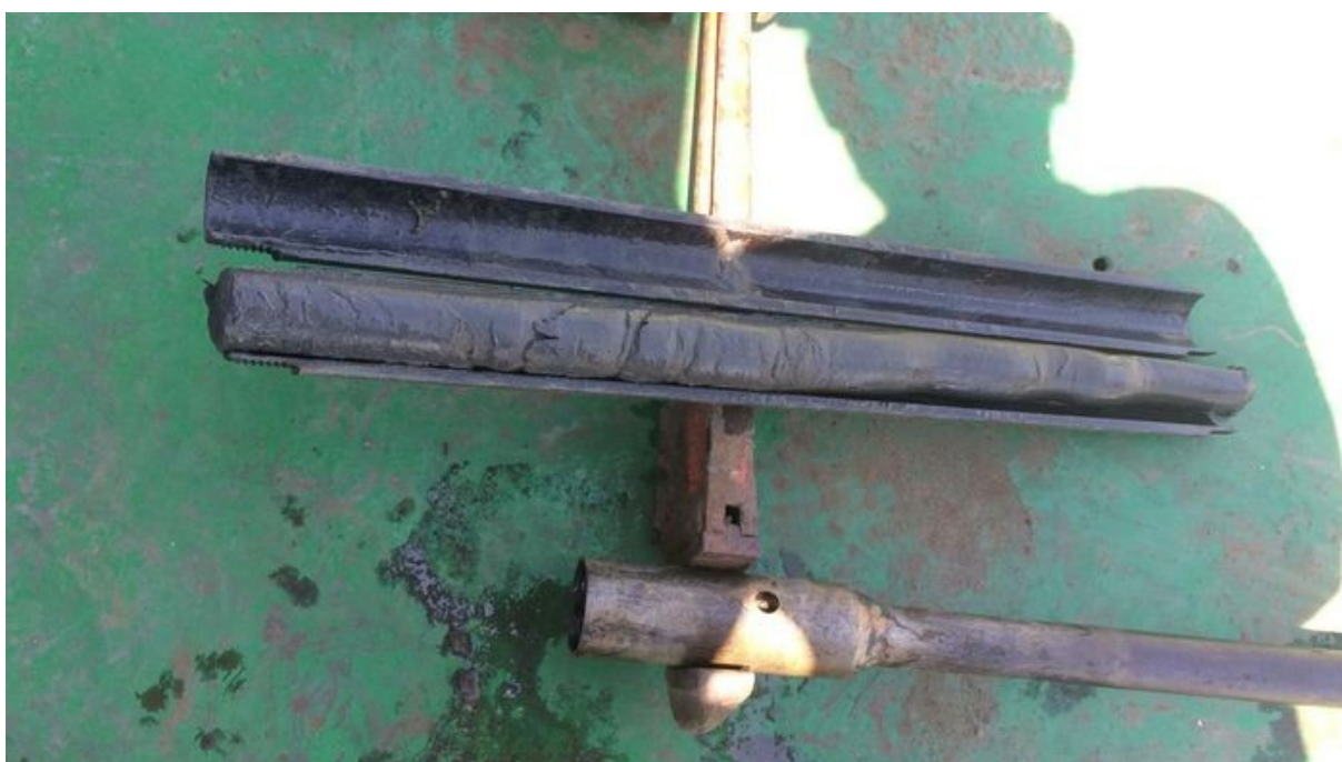
Figura 11 - Testemunho retirado do amostrador.
