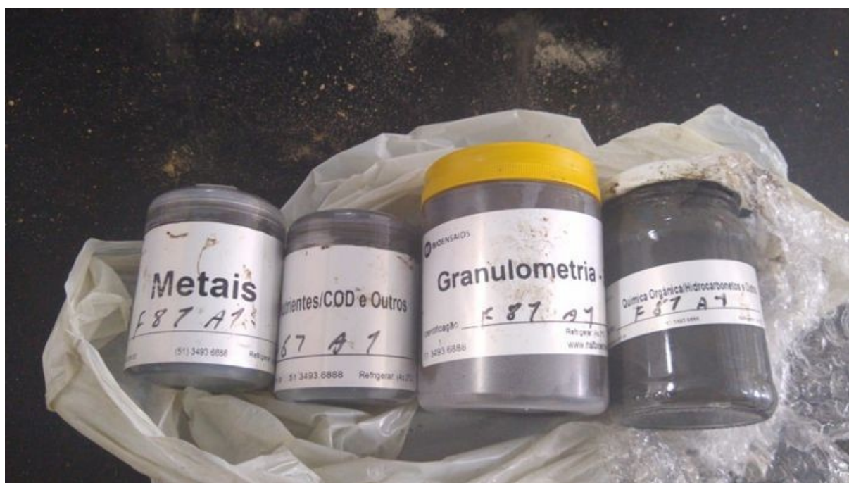
Figura 8 - Amostra F81 A1 subdividida para cada ensaio.
