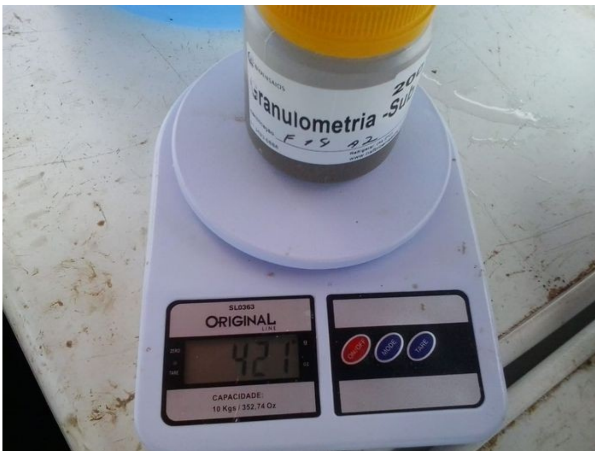
Figura 9 - Sub-amostra F14 A2 para ensaio de granulometria.
