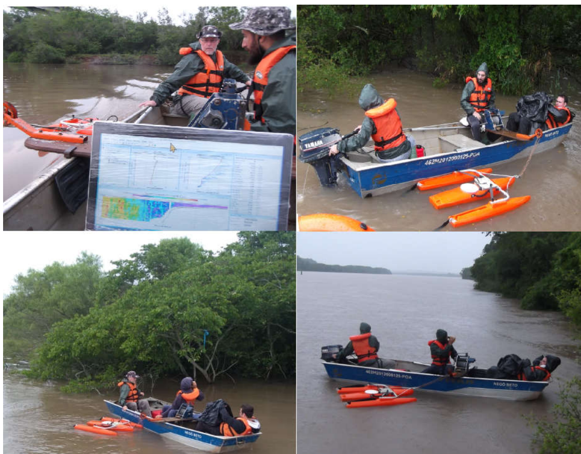
Figura 3.56 - Medição de vazão com ADCP.
