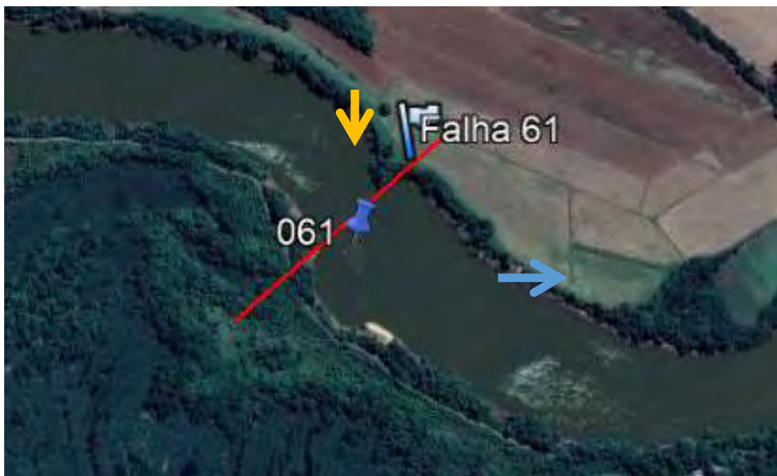
Figura 5.11 – Falha identificada no ponto 61 pela profundidade depois da mesma bem como pela erosão diferencial das margens. (seta azul sentido fluxo hídrico e seta laranja indica local obtenção da imagem da
