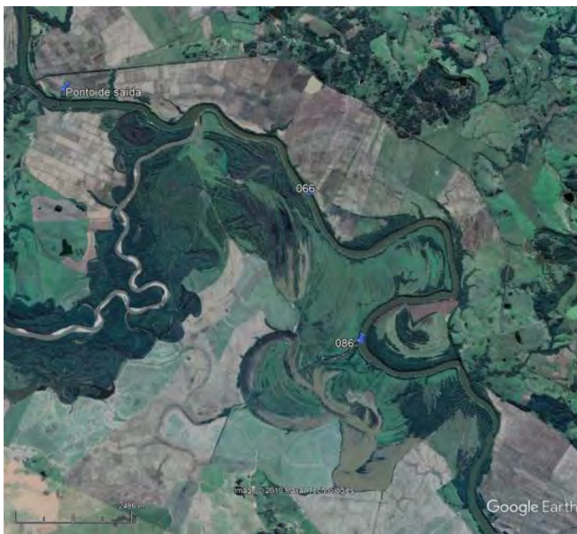
Figura 5.6 – As três classes de um rio com canais simples nos 20 quilômetros iniciais do levantamento de campo, sendo canal reto (ponto de saída), canal sinuoso (ponto 66) e canal meandrante (ponto 86).
