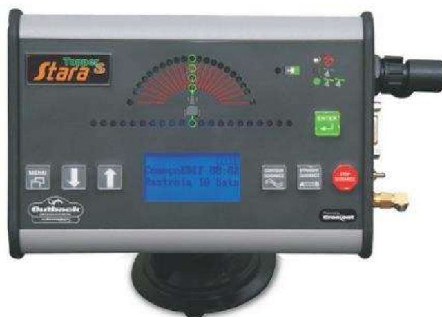
Figura 3.5 Sistema de posicionamento global DGPS de alto desempenho.
