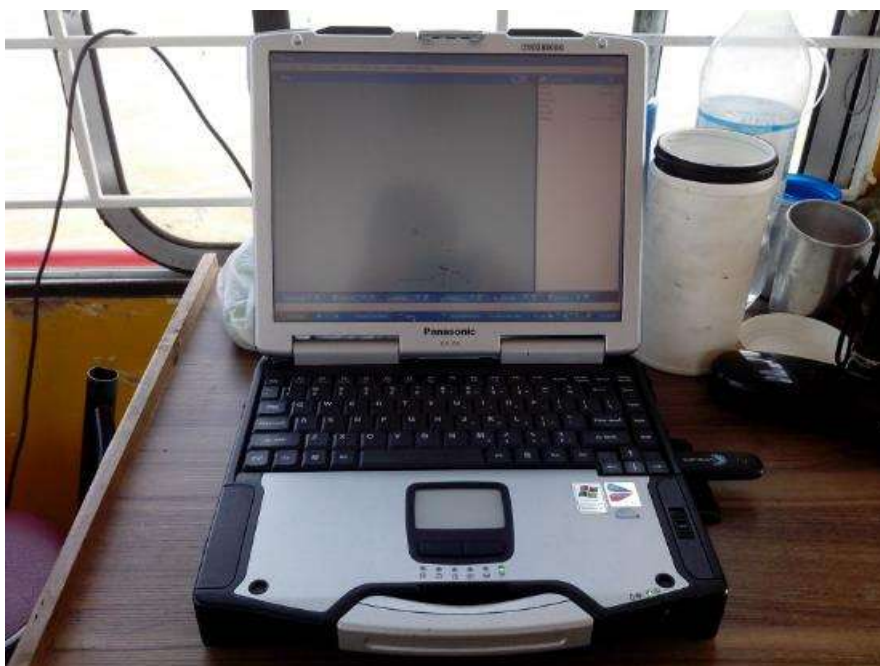
Figura 3.4 - Microcomputador de bordo para o registro digital dos dados em arquivo para posterior processamento.
