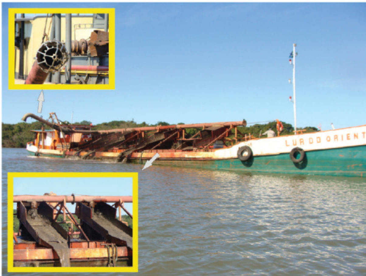
Figura 7.3.3 - Draga flutuante embarcada em ação no baixo Jacuí. No detalhe, são observados a ponta de sucção da draga, e o sistema de peneiramento para retirada da fração cascalho da carga arenosa do leito do rio.
