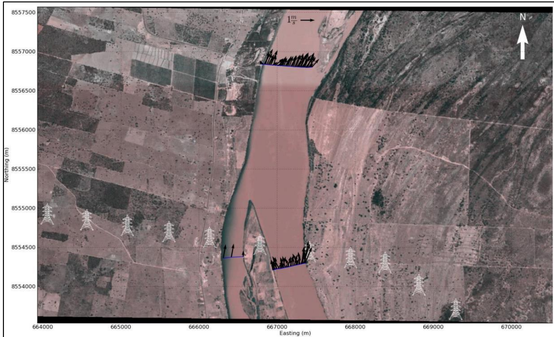
Figura 3.4 - Exemplo de vetores de velocidade das correntes médias ao longo das seções.
