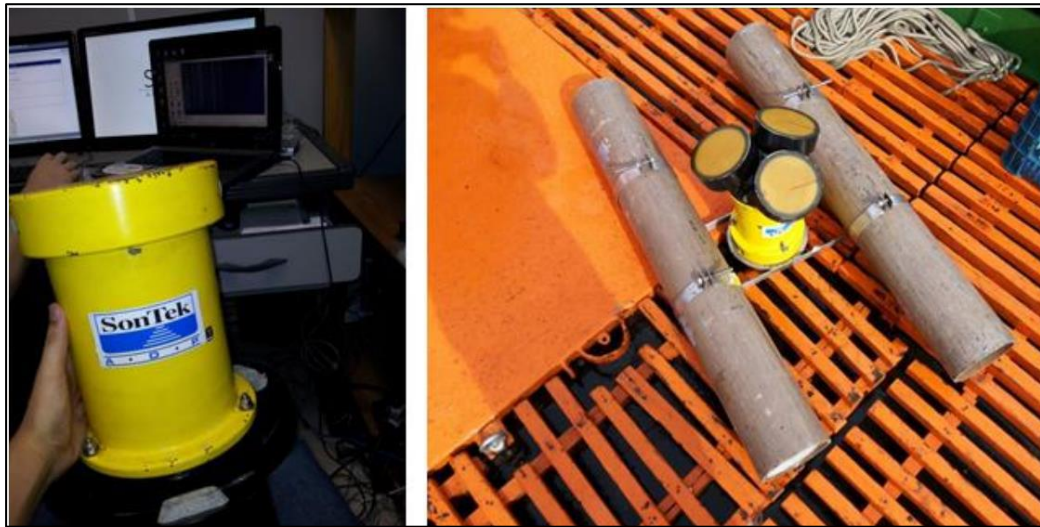
Figura 3.3 - Exemplo de equipamento ADCP e exemplo de estrutura de flutuação tipo catamarã, para aquisição dos dados correntográficos.
